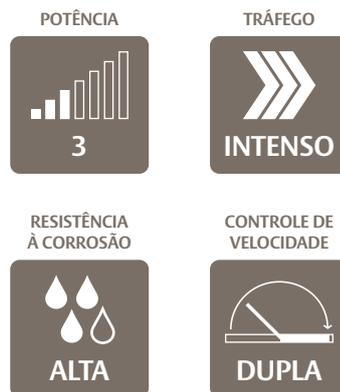
A mola de piso 6500 aplicável em portas de vidro, metal ou madeira. Utilizada em portas simples ou duplas. Versátil, pois possibilita vários ajustes verticais, visando eliminar eventuais e inadequados problemas de fricção da porta, sem a necessidade de pinos adicionais.
